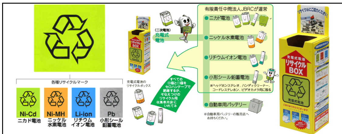
図 38 小型二次電池の種類と回収システム（「社団法人電池工業会」資料より）
