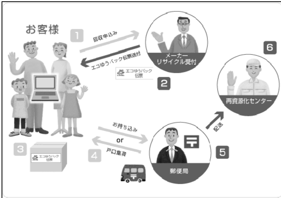
図 37 家庭系パーソナルコンピュータリサイクルのシステム （「パソコン 3 R 推進センター」資料より）
